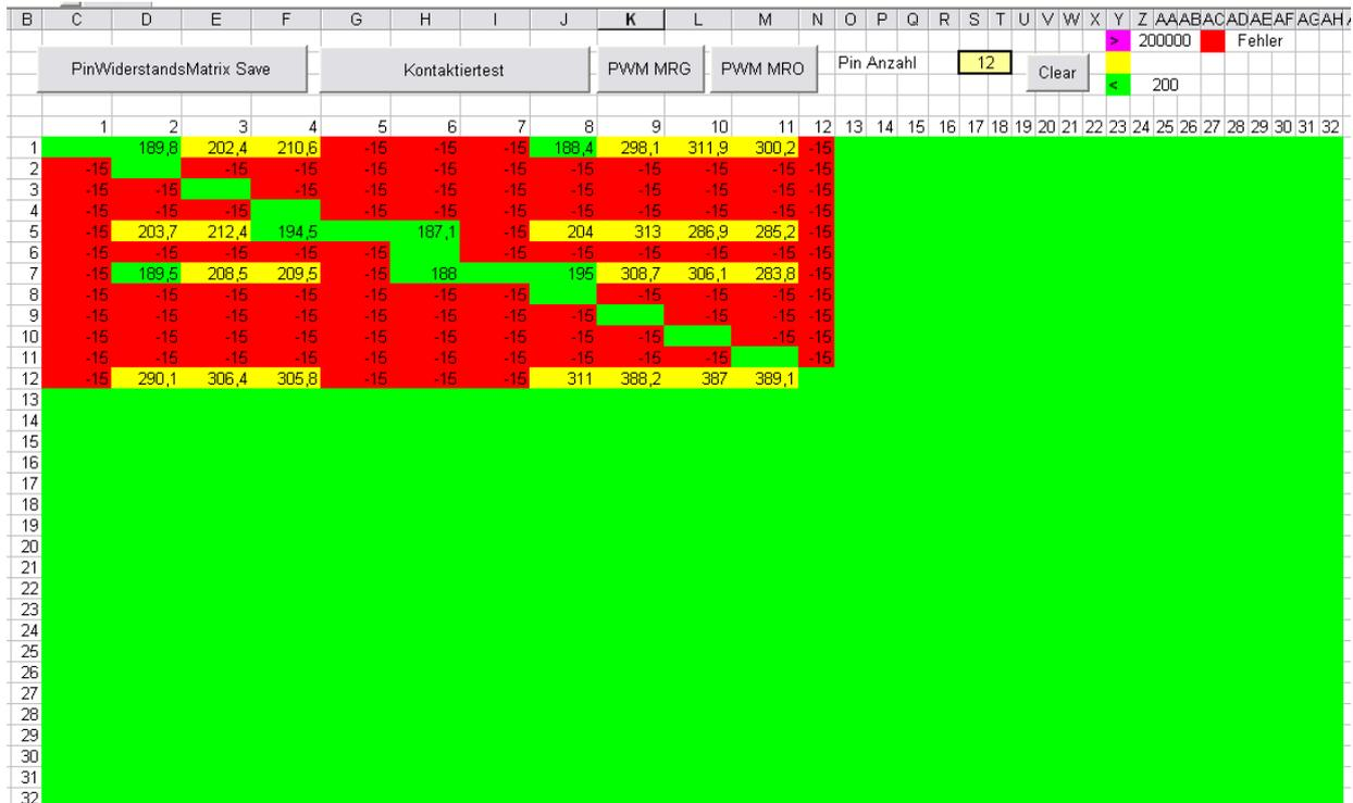
Beispiel für die vollständige kombinatorische Messung eines Prüflings mit 12 Anschlüssen auf einer SMMU mit 32 Anschlusspunkten. Rot angezeigt wird die Überschreitung der Messbereichsgrenze (kein Durchgang) bzw. die gemessenen Widerstandswerte, die über eingestellte Schwellen farbig dargestellt werden. Für die Anwendung in der Serienprüfung kann als Referenz die Matrix an einem bekannt guten Prüfling ermittelt werden und dann über einen Toleranzbereich fehlerhafte Teile identifiziert werden.
